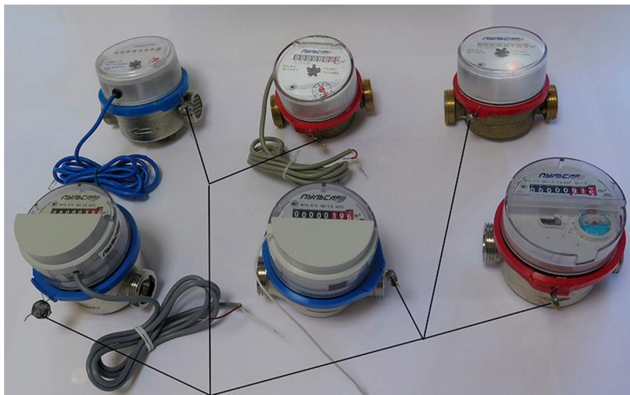
Место пломбировки и нанесения знака поверки
