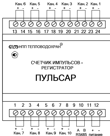
Рис. 7.1 Схема клеммников счетчика
