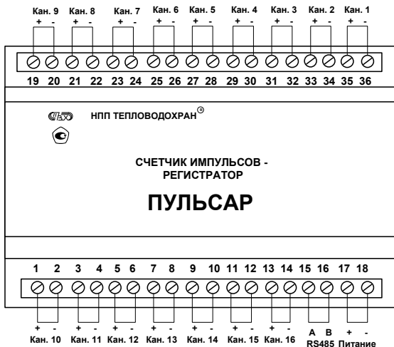
Рис. 7.1 Схема клеммников счетчика
