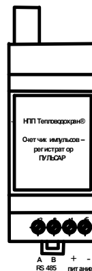
Рис. 7.1 Схема клемников базового модуля
