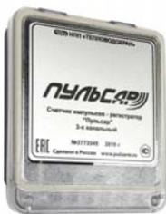
Счетчик импульсов – регистратор 3-канальный с RS485
