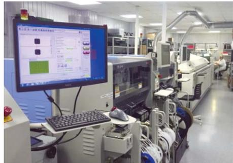
*Линия поверхностного монтажа электронных компонентов*
