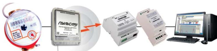
Счетчик воды «Пульсар» с импульсным выходом
