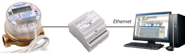
Счетчик воды «Пульсар» с выходом RS485
