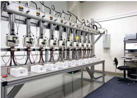
*Стенд поверки и тестирования элетросчетчиков*
